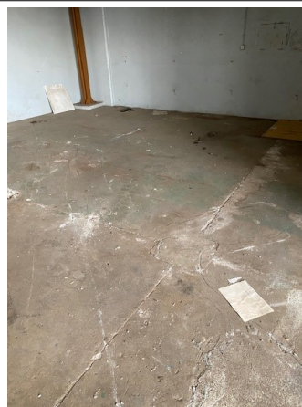
Prélèvement - 0404 : Bâtiment 0061 / RDC / Pièce 016 (Atelier Fer) - Peinture sur béton- (Absence d'amiante)
