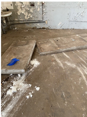
Prélèvement - 0405 : Bâtiment 0061 / RDC / Pièce 016 (Atelier Fer) - Chape maigre- (Absence d'amiante)
